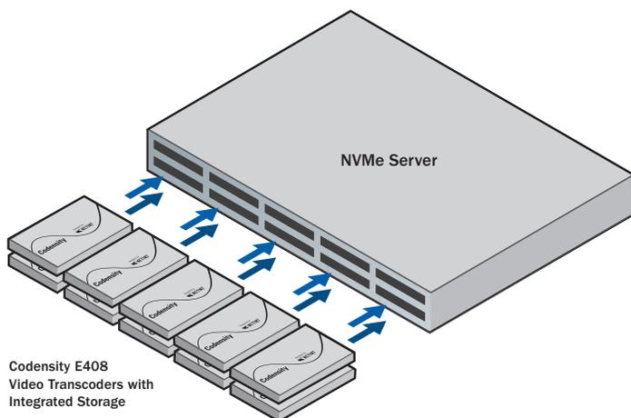
一台普通的 1U NVMe 存储服务器可插入 10 块 T408 模块，可以支持 80 路并行 1080p 高清视频实时转码。
